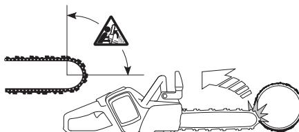
Ja zāģējat ar sliedes apakšu, tas ir, no pārzāgējamā priekšmeta augšas uz apakšu, to var saukt par zāģēšanu vilkšanas režīmā. Šādā gadījumā motorzāģis sevi velk koka virzienā un motorzāģa priekšējā mala ir dabisks balsts darba laikā. Griešana vilkšanas režīmā palīdz jums labāk novalidit motorzāģi un kontrolierāt rāvienu zonas atrašanās vietu.
